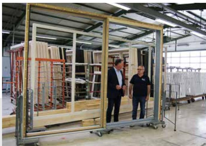
Почти готовый элемент. Снаружи будет монтироваться алюминиевая рама. Здесь видно, как рама элемента скрывается справа за наружной рамой, а площадь стеклянного полотна равна дверному проёму.
