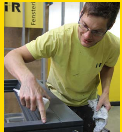
Vor dem Lackiervorgang werden Holzbeschädigungen beseitigt oder Leimrückstände entfernt, damit die Oberfläche möglichst glatt ist.
