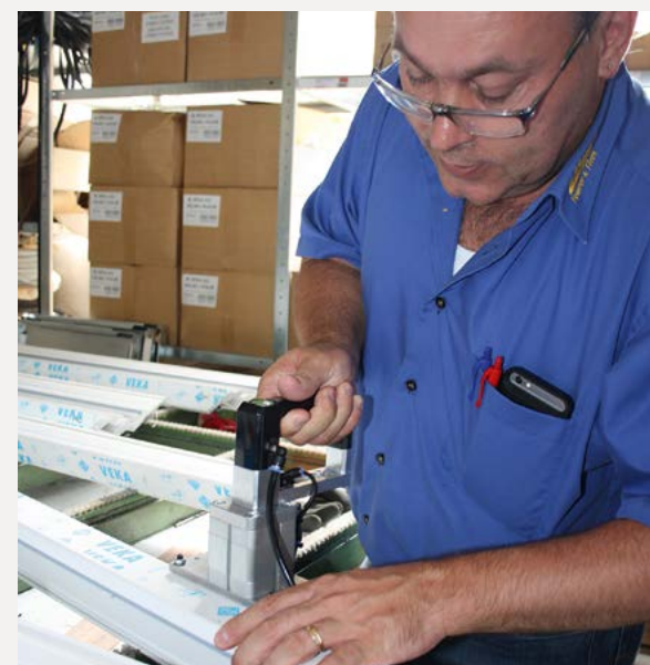
Leo Löffler zeigt die Arbeitsfunktion der Stanze, mit der sich Dichtungen zum Einsatz der Falzlüfter bearbeiten lassen.
