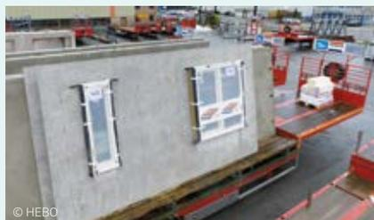
Une autre possibilité est de livrer les châssis à ossature bois finalisés directement aux centrales de béton, qui montent alors ces derniers dans les cadres des fenêtres. Dans les locaux de la centrale de béton, ces cadres de fenêtre sont ensuite installés sur les murs intérieurs. L'ajustement périphérique des cadres de fenêtre est parfait, ce qui réduit la durée de construction.
