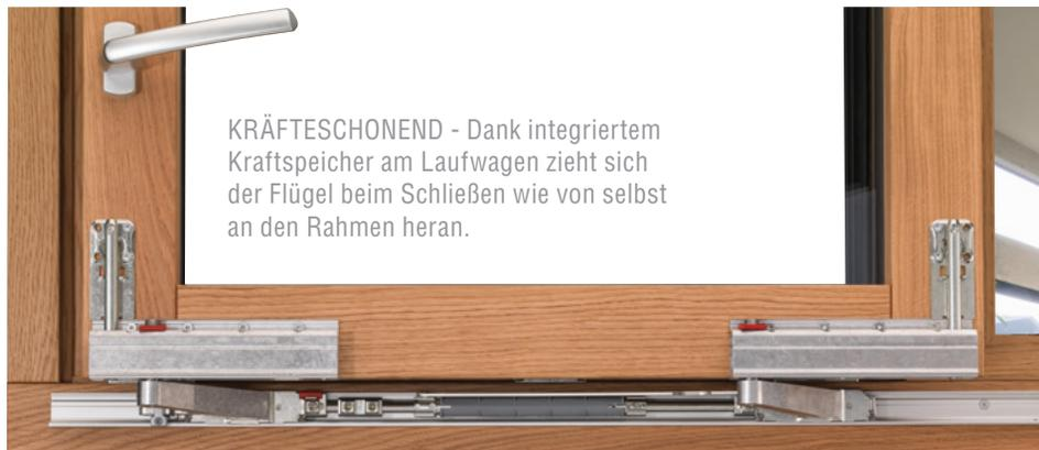
**KRÄFTESCHONEND** - Dank integriertem Kraftspeicher am Laufwagen zieht sich der Flügel beim Schließen wie von selbst an den Rahmen heran.
