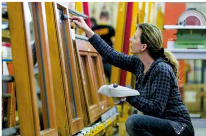
Die manuelle Nassversiegelung mit dem speziellen Silikon sorgt für 100 % Dichtigkeit.
