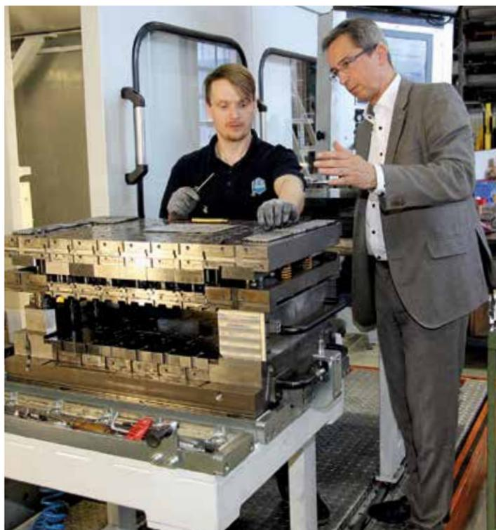
Durch den Wechselseinsatz von Werkzeugschlitten können Stanzformen angepasst und innerhalb von fünf bis zehn Minuten umgerüstet werden. Die Maschine bewegt 1000 kg Stahl in einer halben Sekunde, damit kann MACO nach Kundenbedarf flexibel stanzen.
