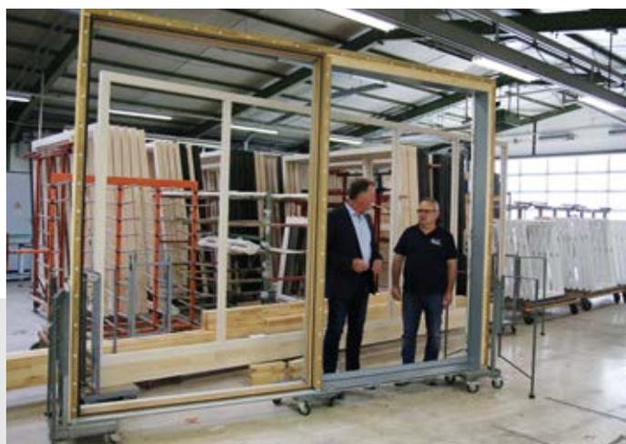
Ouvrant presque terminé. Le cadre en aluminium est encore clipsé à l'extérieur. On voit ici comment le cadre de l'ouvrant disparaît à droite dans le dormant et comment le clair de vitrage est égale au clair de passage.
