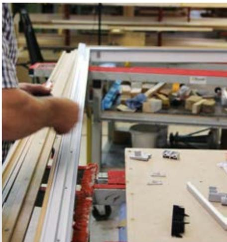
Le rail d'étanchéité est mis en place.
