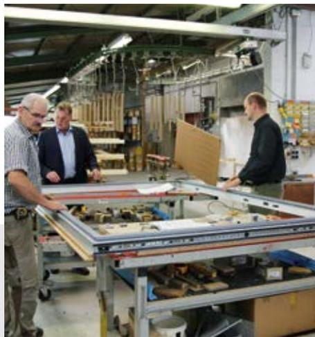
Mise en place de la coque de recouvrement en aluminium.
