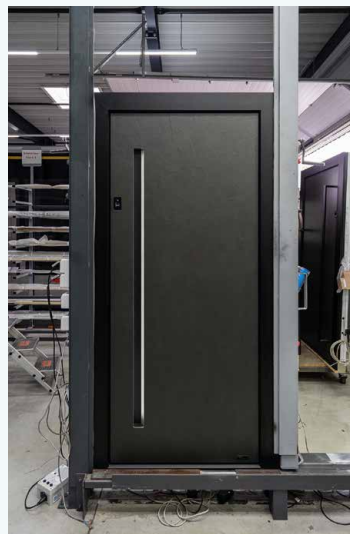
Dveře řady Signature s uzávěrem INSTINCT na zkušební stoli. Köster Aluminium rád používá zapuštěné kliky na vnitřní i vnější straně minimalistického dvevního křídla.
