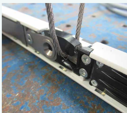
Zkušební vzorky při provádění dlouhodobých funkčních a zátěžových testů podle EN 14846 v íft Rosenheim.
