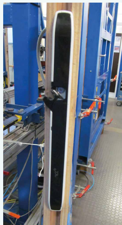
Zkušební vzorky při provádění dlouhodobých funkčních a zátěžových testů podle EN 14846 v íft Rosenheim.
