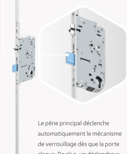
Le pêne principal déclenche automatiquement le mécanisme de verrouillage dès que la porte claque. De plus, un déclencheur magnétique contrôle la bonne fermeture : deux critères pour un verrouillage sûr. Deux crochets et le verrou de fermeture, unique en son genre, sortent automatiquement. La porte est triplement verrouillée, sans clé. Des points de verrouillage supplémentaires sont possibles.
